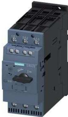
Leistungsschalter Baugröße S2 für den Motorschutz, CLASS 10 A-Auslöser 14...20 A N-Auslöser 260 A Schraubanschluss erhöhtes Schaltvermögen mit querliegenden Hilfsschalter 1S+1Ö
