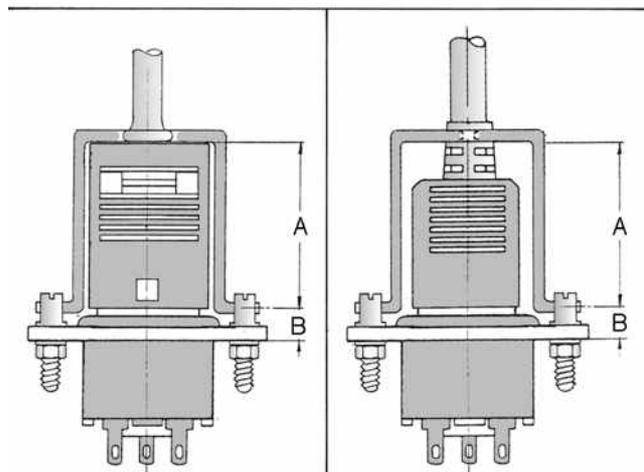
Um optimale Klemmwirkung zu erzielen, muss -Mass A- in Verbindung mit der Kopflänge der Halteschrauben -Mass B- genau auf die Länge der Kabelsteckdose bzw. die Rillen der Kabeltülle abgestimmt werden.
