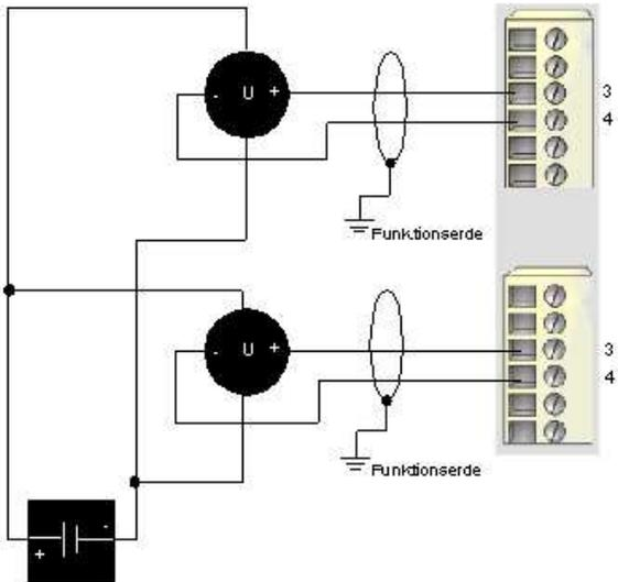
2 potenzialgetrennte analoge Aktoren, externe 24-VDC-Stromversorgung
