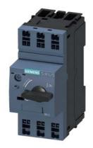
Leistungsschalter Baugröße S00 für den Motorschutz, CLASS 10 A-Auslöser 0,22...0,32 A N-Auslöser 4,2 A Federzuganschluss Standardschaltvermögen
