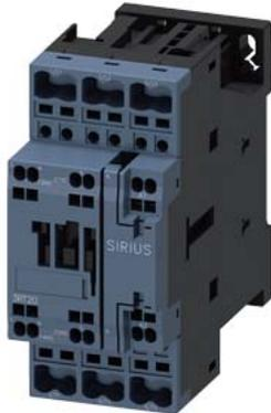
Leistungsschütz, AC-3 17 A, 7,5 kW / 400 V 1 S + 1 Ö, AC 220 V, 50 / 60 Hz, 3-polig, Baugröße S0, Federzuganschluss
