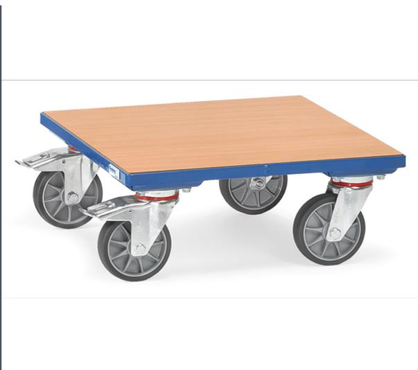
Aus Winkelstahl, geschweißt, pulverbeschichtet blau RAL 5007. Ladefläche aus Holzwerkstoffplatte, Oberfläche Buchendekor. 4 Lenkrollen, TPE-Bereifung, Naben mit Rillenkugellager. 2 Stück mit Feststeller, gemäß der Europäischen Norm EN 1757-3 (Sicherheit von Plattformwagen).
