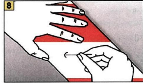
7. Folie bei Verklebung über Blechstöße der Fahrzeugkonstruktion nach der Verklebung durchschneiden und die Ecken gut andrücken.
