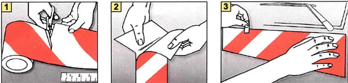
1. Länge der zu beklebenden Fläche ausmessen und Folie entsprechend von der Rolle schneiden.
