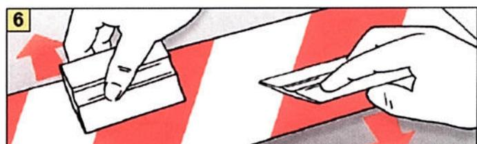
4. Schutzpapier langsam unter der Folie abziehen und gleichmäßig mit Plastikraker andrücken
