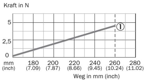
① Maximaler Anpressdruck in Abhängigkeit der Montageposition des Gegengewichts (260 mm)
