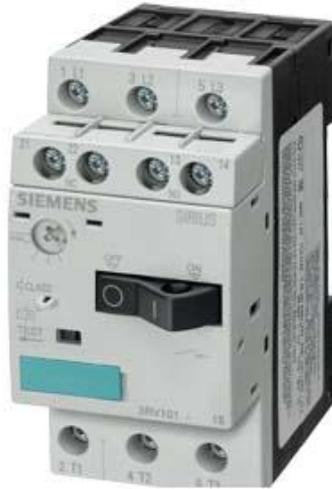
LEISTUNGSSCHALTER BGR. S00, FUER DEN MOTORSCHUTZ, CLASS 10, A-AUSL.0,22...0,32A,N-AUSL.4,2A SCHRAUBANSCHLUSS, STANDARDSCHALTVERMOEGEN, MIT QUERL. HILFSSCHALTER 1S+10E
