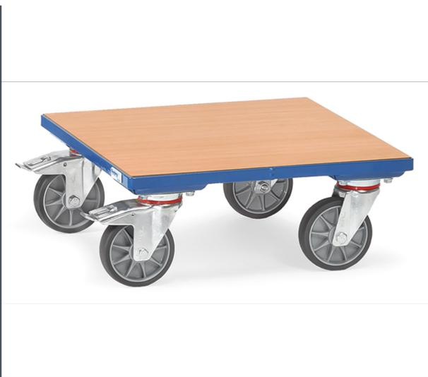
Plateau roulant en profilé d'acier avec plateau bois, revêtement époxy bleu RAL 5007. 4 roues pivotantes à bandage TPE 125 x 32, moyeu à roulement à billes central. 2 roues avec freins conformément à la Norme EN 1757-3.
