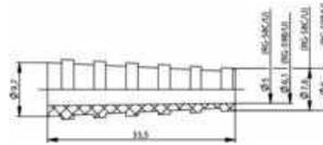
Knickschutztülle G1 (RG-58C/U) Kurze Ausführung, RAL 9005 tiefschwarz
