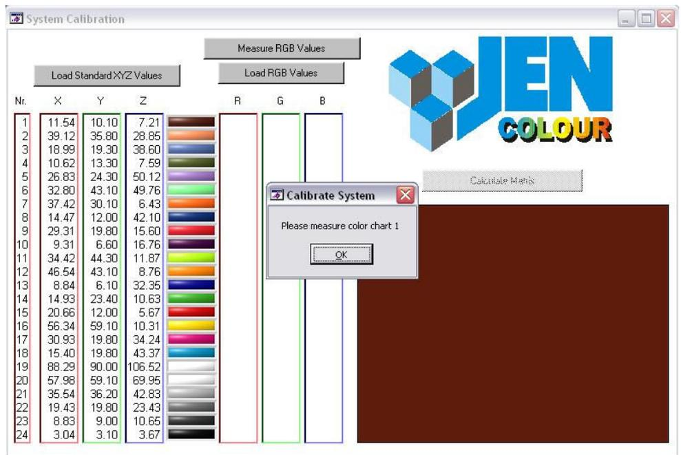
Figure 28: System calibration – determination of actual values
