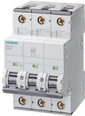
Leitungsschutzschalter 400V 10kA, 3-polig, C, 10A, T=70mm
