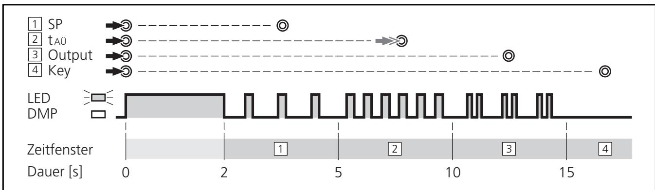
Der Einstellvorgang ist in ca. 3 und 5 Sekunden andauernde Zeitfenster unterteilt. Innerhalb eines Zeitfensters erfolgt das Speichern der zugeordneten Einstellung durch das Loslassen der gedrückten Taste. Die Zeitfenster werden durch unterschiedliche Blinkfrequenzen der „DMP“-LED dargestellt.
