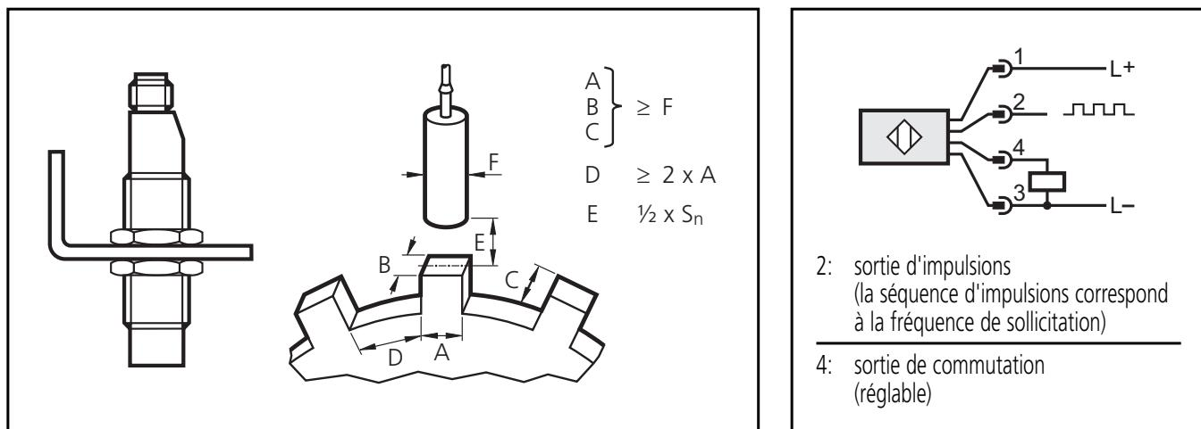
Fixez l'appareil à l'aide d'un dispositif de fixation et protégez-le contre le desserrage à l'aide des écrous fournis. Non encastrable.
