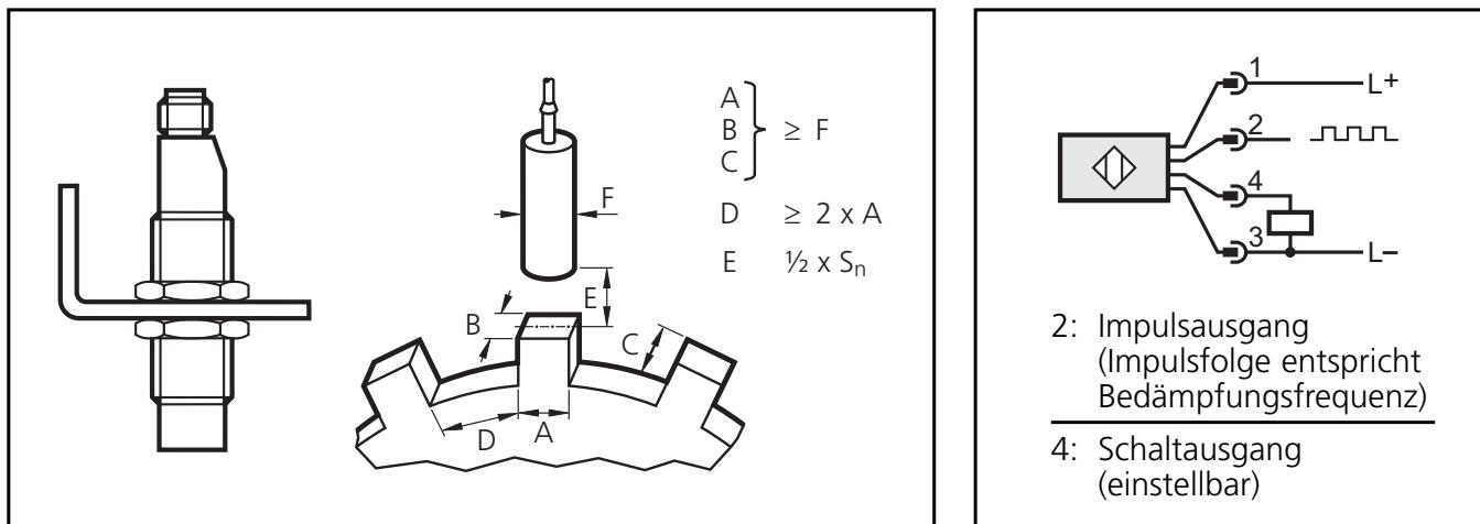
Das Gerät mit Hilfe einer Montagehalterung befestigen und mit den beigepackten Muttern gegen Loslösen sichern. Nicht bündig einbaubar.
