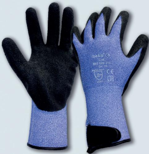
Latex-beschichteter Spezialhandschuh mit schnittfester HPPE-Faser, guter ergonomischer Sitz mit gutem Tragkomfort durch Klettriegelverschluss am Handgelenk, hohe Schnitt- und Durchstichfestigkeit, atmungsaktiv, optimale Rutsch- und Abriebfestigkeit.
