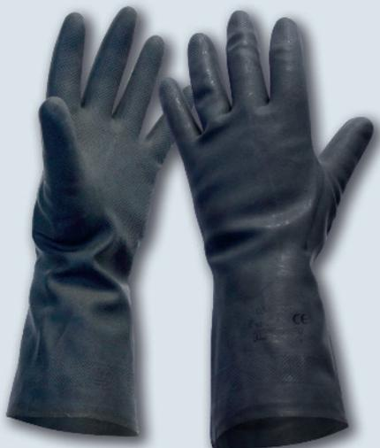
Hochwertige Latex/Neopren-Mischung für speziellen Schutz vor Flüssigkeiten und Chemikalien, mit langen Stulpen, Innenseite velourisiert, Wandstärke: 0,7 mm, nahtlos, lebensmittelgeprüft, gutes Tastgefühl.
