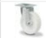
roulette pivotante, force 175 kg, avec bandage plastique, diamètre x largeur 125 x 35 mm, moyeu avec roulement à rouleaux, jante en plastique, fixation avec panneau, longueur x largeur 105 x 80 mm
