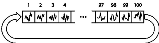
Wenn die Kurvenlänge kürzer als der Speicher des Oszilloskops eingestellt ist, konfiguriert das PicoScope den Speicher automatisch als Ringpuffer, sodass die letzten erfassten Wellenformen abgerufen werden können. Wenn z. B. 1 Million Abtastungen erfasst werden, speichert das Oszilloskop bis zu 500 Wellenformen. Mithilfe von Werkzeugen wie Maskengrenzprüfungen kann dann jede Wellenform untersucht werden, um Anomalien zu identifizieren.
