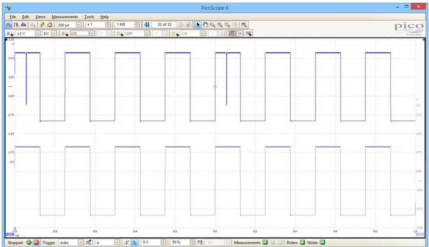
Im obigen Beispiel stellen beide Wellenformen dasselbe Signal mit verschiedenen Verfahren für die Hardwarebeschleunigung dar. Bei der oberen Wellenform wurde die bei PicoScopes mögliche Aggregation verwendet, sodass die Hochfrequenzspitzen erhalten geblieben sind. Bei der unteren Wellenform wurde die herkömmliche Dezimierung angewendet, wodurch es zu einem Verlust an Hochfrequenzinformationen gekommen ist.
