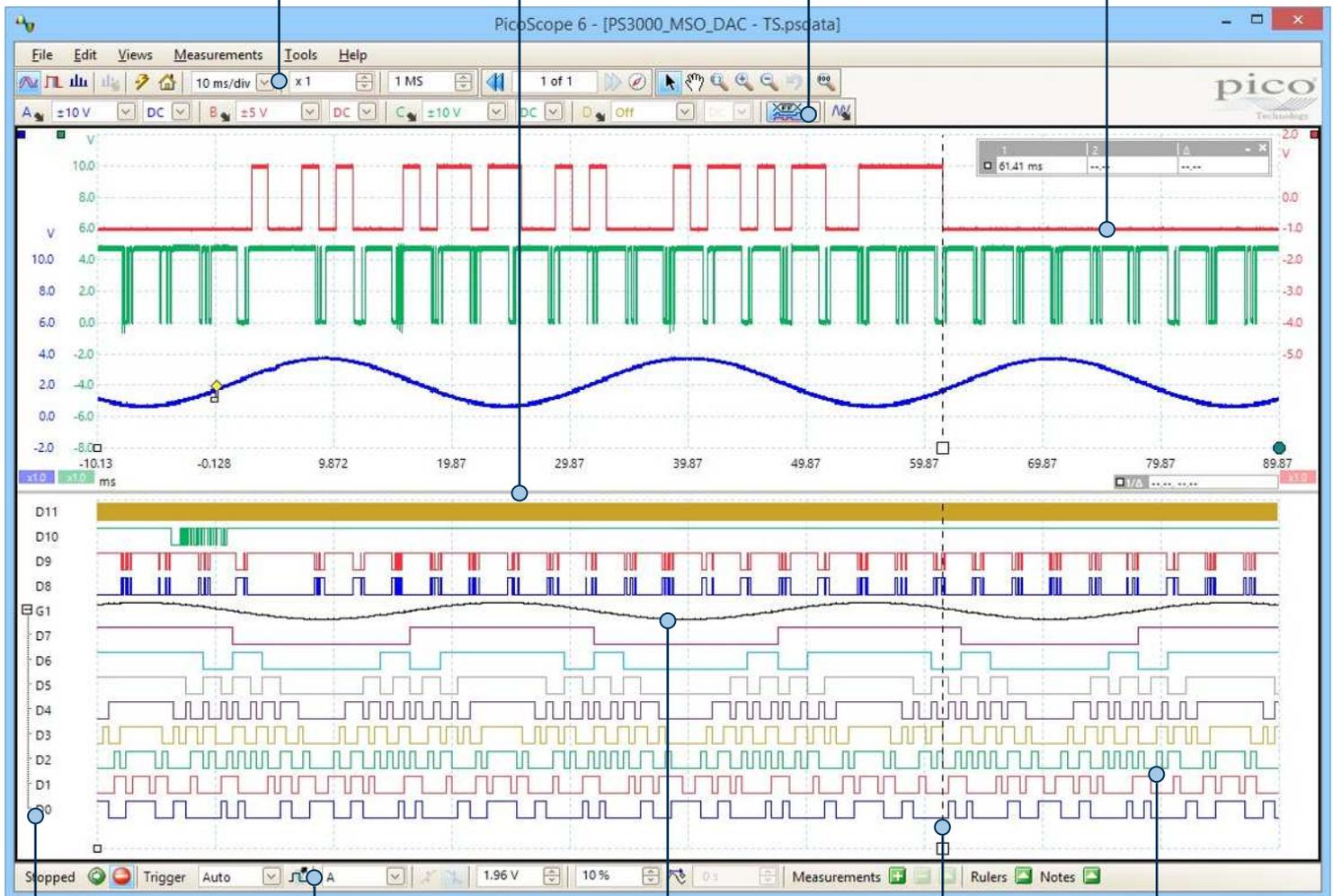
**Erweiterte Trigger:** Für digitale Kanäle sind zusätzliche Digital- und Logiktrigger-Optionen verfügbar.
