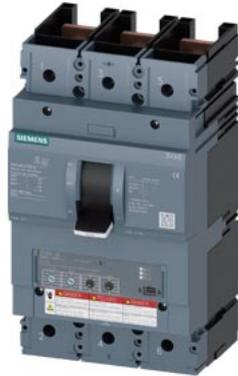
Leistungsschalter 3VA6 UL Frame 400 Schaltvermögenklasse M 35kA @ 480V 3-polig, Anlagenschutz ETU350, LSI, In=250A Überlastschutz Ir=100A...250A Kurzschlusschutz Isd=1,5...10 x Ir, li=12 x In ohne Anschluss
