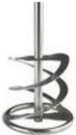
Zwei rechts geformte Wendeln zum Kneten und Mischen von zähen bis pastösen Materialien. Der Rührstab schraubt sich selbst nach unten und drückt das Mischgut nach oben. Sehr vielseitig einsetzbar für: Fliesenkleber, Fugenmasse, Spachtelmasse, Fertigputz, Klebemörtel, Ausgleichsmasse, Estrich.
