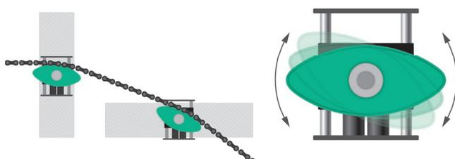
Elliptisches, 180° drehgelagertes Kettengleitprofil. Bei Verschleiß einer Seite kann das Profil einfach gedreht und die andere Seite genutzt werden.
