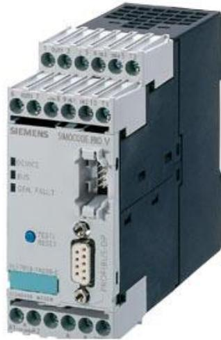
GRUNDGERAET 2 SIMOCODE PRO V; PROFIBUS DP-SCHNITTSTELLE 12 MBIT/S, RS485; 4E/3A FREI PARAMETRIERBAR; US: DC 24V; EINGANG F. THERMISTORANSCHLUSS; MONOSTABILE RELAISGAENGE; ERWEITERBAR DURCH ERWEITERUNGSMODULE
