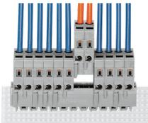
Bei diesen Federleisten ist die Abschlussplatte, ohne über das Teilungsmaß überzustehen, in das Isoliergehäuse integriert – und das ohne Einschränkungen beim Nennquerschnitt. Damit reduziert sich die Gesamtlänge der Federleisten auf das Maß „Polzahl x Rastermaß“!
