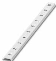
Zackband flach, Streifen, weiß, beschriftet, längs bedruckt: fortlaufende Zahlen 1 ... 10, 11 ... 20 usw. bis 101 ... 110, Montageart: verrasten, für Klemmenbreite: 8 mm, Schriftfeldgröße: 5,15 x 8,15 mm, Anzahl der Einzelschilder: 10
