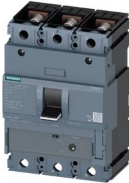
Leistungsschalter 3VA1 IEC Frame 250 Schaltvermögenklasse H Icu=70kA @ 415V 3-polig, Starterschutz TM120M, AM, In=200A ohne Überlastschutz Kurzschlusschutz li=6...14 x In Schraubenflächanschluss
