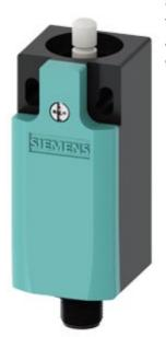
Basisschalter/Komplettschalter, Kunststoffgehäuse nach DIN EN 50047, 31 mm, 1S/2Ö Sprungkontakte, mit M12-Stecker, 5-polig, 2Ö angeschlossen. Pin-Belegung: Pin1=21, Pin4=22 Pin2=31, Pin5=32 für maximal 125 V und 4 A mit Teflonstößel. Geeignet zum Anschluss an alle SIMATIC ET200\* kompakte Blockperipherie gruppen.
