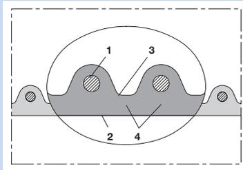
Antistatischer Polyurethanschlauch, superschwer, mikrobefest
