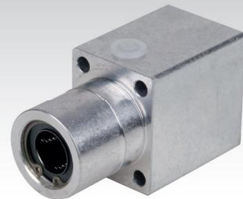
**Werkstoff:** Stranggepresstes Aluminiumgehäuse mit sauber gefräster Auflagefläche und präzisiertem Passungsdurchmesser. Mit zwei geschlossenen Linearkugellagern der ISO-Reihe 3 mit Stahlmantel und Kunststoffkäfig. Die Lager sind beidseitig abgedichtet und einbaufertig befüllt.
