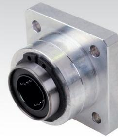
**Werkstoff:** Stranggepresstes Aluminiumgehäuse mit sauber gefräster Auflagefläche und präzisiertem Zentriersatz  $D_f$ . Mit einem geschlossenen Linearkugellager der ISO-Reihe 3 mit Stahlmantel und Kunststoffkäfig. Die Lager sind beidseitig abgedichtet und einbaufertig befüllt.
