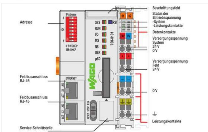
Der Controller PFC100 ist eine kompakte Steuerung an dem modularen WAGO I/O System. Neben den Netzwerk- und Feldbusschnittstellen unterstützt er digitale und analoge Module sowie Sondermodule der Serien 750/753.
