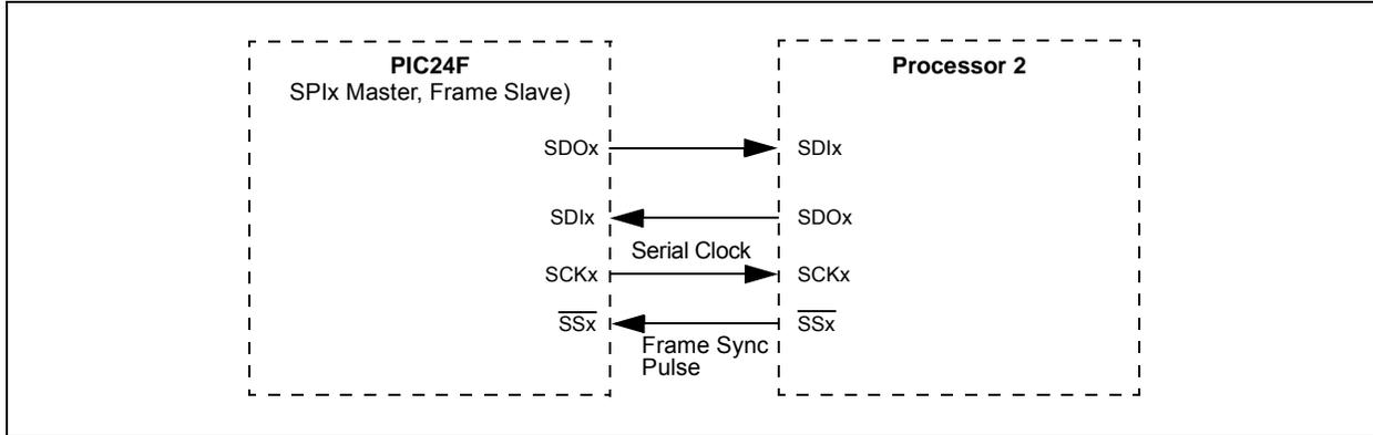
**FIGURE 17-7: SPIx SLAVE, FRAME MASTER CONNECTION DIAGRAM**
