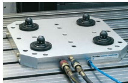
Stół maszyny: Płyta bazowa z 4 elementami łączącymi
