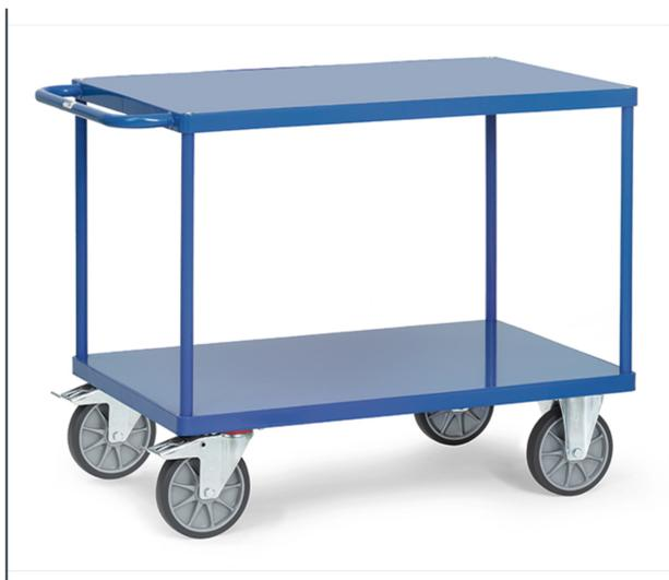
Système modulaire : ensemble mécano-soudé, revêtement époxy RAL 5007, assemblé selon le principe des "inserts fetra". Plateau en tôle d'acier soudé de niveau dans l'armature. 2 roues pivotantes et 2 fixes à bandage TPE, moyeu à roulement à billes central. Freins sur roues pivotantes conformément à la Norme Européenne EN 1757-3 (Sécurité des chariots de manutention). Charge maximum plateau du haut : 200 kg.
