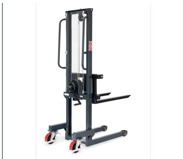
Construction très solide en tôle d'acier, avec dossier de poussée en tube d'acier, revêtement époxy Gris Anthracite RAL 7016. Sans entretien, levée par manivelle sécurisée. 2 fourches réglables en largeur. 2 roues directrices à bandage polyuréthane 150 x 40 mm et 2 galets à bandage polyuréthane 80 x 47 mm. Roues directrices avec freins. Largeur de fourche : 75 mm. Montée par tour de manivelle : 40/22 mm.
