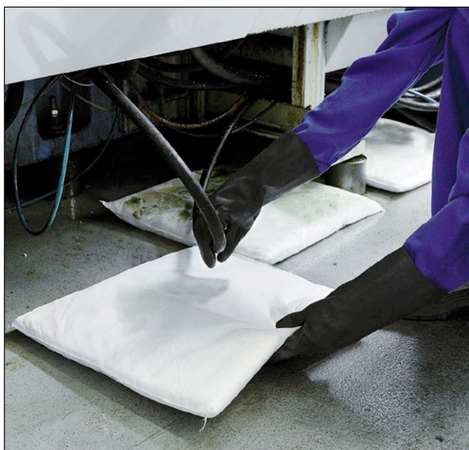
Kissen zum Auffangen lästiger Öltropfen an Maschinen.
