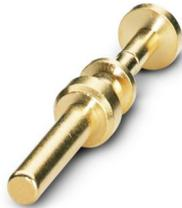
Crimpkontakt, Stift, gedreht, Einzelkontakt, Kontaktdurchmesser: 3,6 mm, Crimpbereich: 0,25 mm<sup>2</sup> ... 2,5 mm<sup>2</sup>, Artikel ist bleifrei nach RoHS II ohne Ausnahme 6c (Pb < 0,1 %)
