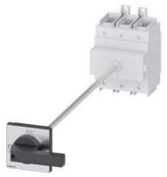
SENTRON, Lasttrennschalter 3LD, Hauptschalter, 3-polig, lu=250A, Betriebsleistung / bei AC-23 A bei 400V: 132 kW, Bodenbefestigung mit Türkupplung, Knebelantrieb, schwarz, 4-Loch Befestigung der Handhabe
