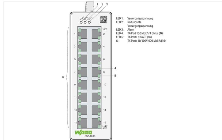
Der 852-1816 ist ein industrieller, konfigurierbarer ETHERNET-Switch mit 16 Ports 10/100/1000BASE-T.
