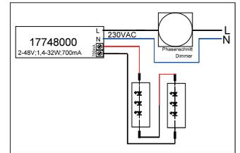
LED-Konverter 700 mA, Phasenabschnitt dimmbar. Dieses Betriebsgerät erfüllt die Anforderungen für Sicherheitsbeleuchtungsanlagen nach DIN EN 50172 VDE 0108-100:2005-01. Dieser Konverter ist durch Sicherungseinrichtungen gegen Überspannung und Kurzschluss sowie thermische und elektrische Überlastung geschützt. Die Eingangs- und die Ausgangsklemme ist für Leitungen mit einem Querschnitt von bis zu 1,5 mm<sup>2</sup> geeignet.
