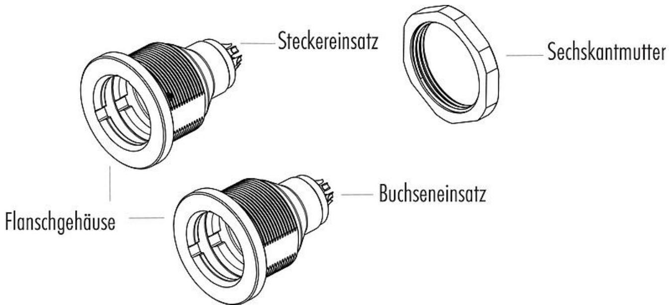
Bezeichnung Push-Pull Flanschdose, Polzahl: 4, schirmbar, löten, IP67
