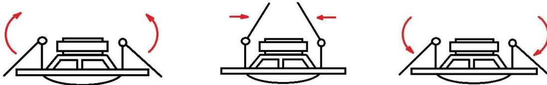
Um den Lautsprecher in Ihre Einbauöffnung, an der Wand oder Decke, einzuführen, ziehen Sie die beiden Haltefedern nach oben. Führen Sie nun die Rückseite des Lautsprechers in die Einbauöffnung ein und lassen Sie die Federn nun wieder in Ihre Ursprungsposition gleiten. Achten Sie darauf, dass die Anschlussleitung der Lautsprecher vorher angeschlossen wurde und die Federn beim Loslassen nicht unkontrolliert zuschnappen (Verletzungsgefahr!).
