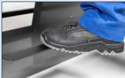
Der Deckel wird mittels Fußpedal geöffnet. Der Schließvorgang erfolgt selbsttätig bei Loslassen des Pedals. Eine Gasdruckfeder sorgt für ein langsames Schließen, somit wird die Gefahr von Klemmverletzungen minimiert.
