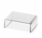
Strangprofilgehäuse, Verrastung, Abdeckung, Farbe: transparent, Breite: 73 mm, Profillänge (konfigurierbar): 3 cm ... 100 cm, Höhe: 24 mm, Hinweis: max. Länge der Abdeckung = Leiterplattenlänge - 19 mm
