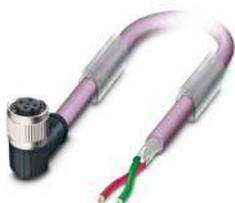
Bussystem-Kabel, PROFIBUS (12 MBit/s), 2-polig, PUR halogenfrei, violett RAL 4001, geschirmt, freies Leitungsende, auf Buchse gewinkelt M12 SPEEDCON, Kodierung: B, Kabellänge: Freie Eingabe (0,2 ... 40,0 m)
