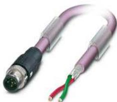
Bussystem-Kabel, PROFIBUS (12 MBit/s), 2-polig, PUR halogenfrei, violett RAL 4001, geschirmt, Stecker gerade M12 SPEEDCON, Kodierung: B, auf freies Leitungsende, Kabellänge: 2 m
