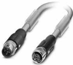
Bussystem-Kabel, PROFIBUS (12 MBit/s), 2-polig, PUR halogenfrei, violett RAL 4001, geschirmt, Stecker gerade M12 SPEEDCON, Kodierung: B, auf Buchse gerade M12 SPEEDCON, Kodierung: B, Kabellänge: Freie Eingabe (0,2 ... 40,0 m)
