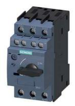
Leistungsschalter Baugröße S00 für den Motorschutz, CLASS 10 A-Auslöser 1,1...1,6 A N-Auslöser 21 A Schraubanschluss Standardschaltvermögen mit querliegenden Hilfsschalter 1S+1Ö
