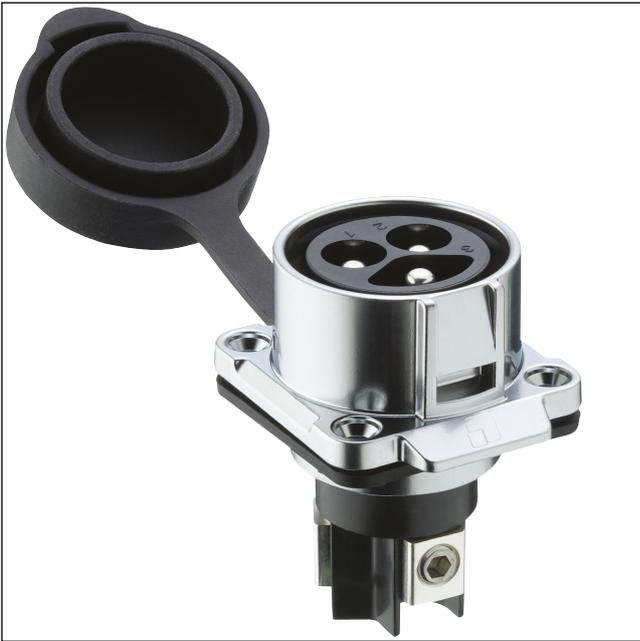
Quicklock-Flansch-Einbaustecker, IP67, Größe 28, gerade Ausführung, mit Metallgehäuse, Schraubklemmanschlüssen und Schutzkappe (IP65)
