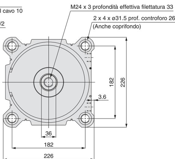
Nota 1) Nel caso di una corsa da 20 mm o meno, viene fornita con filettatura passante 2 x 4 x M22 x 2.5.
