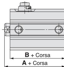
**Bloccaggio su testata anteriore** (mm)
