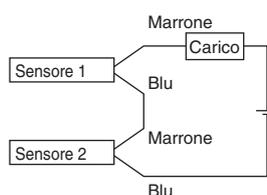
Quando due sensori vengono collegati in serie, si potrebbe verificare un malfunzionamento a causa della diminuzione della tensione di carico in condizione attivata. Gli indicatori ottici si illuminano quando entrambi i sensori sono attivati.
