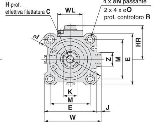
Dimensioni dispositivo bloccaggio finale (mm)
