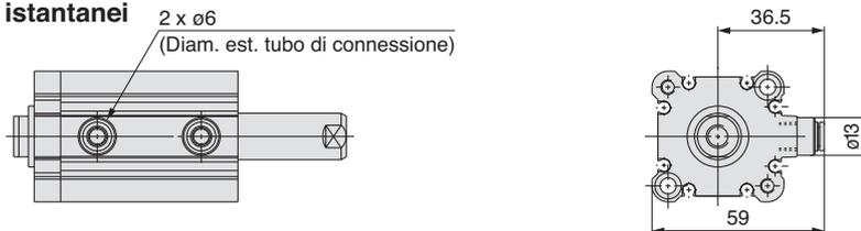
\* Le dimensioni della corsa Ø32-5 mm con raccordi istantanei integrati sono le stesse di quelle del tubo del cilindro con corsa 10 mm. (mm)
