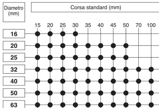
• Realizzazione corse intermedie Sono disponibili corse intermedie in intervalli di 1 mm mediante l'installazione di un distanziale nel cilindro a corsa standard.
