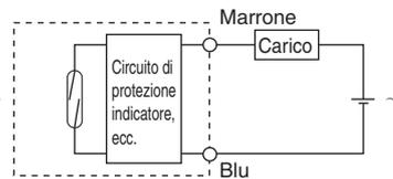
(Le alimentazioni del sensore e del carico sono separate).
