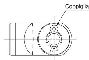
\* Per il supporto di montaggio, sono consegnate insieme le coppiglie, il perno snodo e le rondelle piatte, ma non assemblate.
