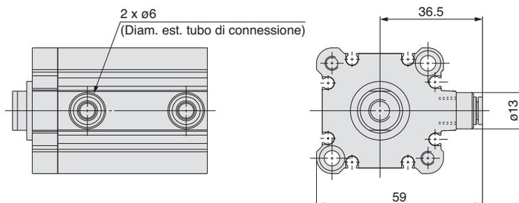
Nota 2) Le dimensioni della corsa Ø32-5 mm con raccordi istantanei integrati sono le stesse di quelle del tubo del cilindro con corsa 10 mm.
