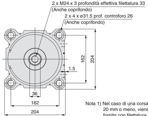
Nota 1) Nel caso di una corsa da 20 mm o meno, viene fornita con filettatura passante 2 x 4 x M22 x 2.5.
