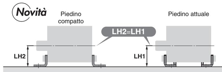
Cilindri applicabili: C(D)Q2, C(D)Q2W, C(D)Q2 (semplice effetto) (molla anteriore/molla posteriore), C(D)Q2K, C(D)Q2KW (antirotazione), C(D)Q2 (corsa lunga), C(D)Q2□S (resistente ai carichi laterali), C(D)BQ2 (bloccaggio a finecorsa), C(D)Q2□R/□V (resistente all'acqua)
