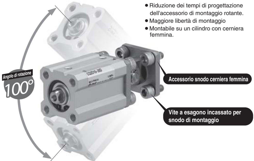
Cilindri applicabili: CQ2 (diametro  $\varnothing 12$  a  $\varnothing 100$ , accessorio di montaggio, applicabile solo a cerniera femmina).
