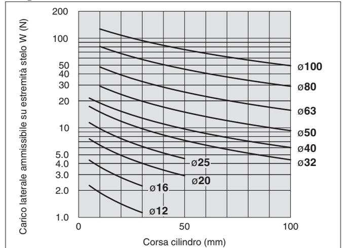
Se un carico laterale ammissibile all'estremità stelo supera il valore indicato nel grafico, raccomandiamo di usare un cilindro a bussola rinforzata.
