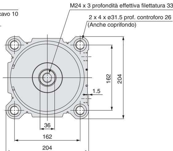
Nota 1) Nel caso di una corsa da 20 mm o meno, viene fornita con filettatura passante 2 x 4 x M22 x 2.5.
