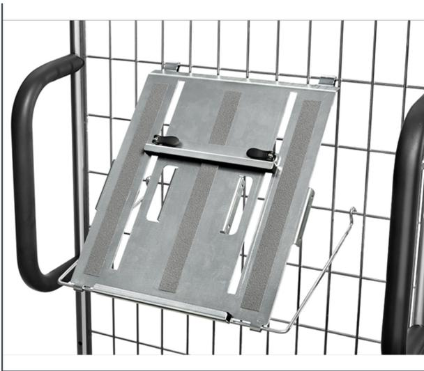
Stahlblech verzinkt. Bei verzinkten Kommissionierwagen in Stirnwand einhängbar. Neigung mittels Stützbügel einstellbar. Tablets und Smartphones werden sicher und schonend mit Exzentranspannern fixiert. Klemmleisten mit Moosgummi gepolstert, Antirutschbelagstreifen zur individuellen Selbstanbringung. Klemmbereich B x H x T: 200 x 15-295 x 14 mm Lieferung inkl. Adapter für den Anbau an MultiVario-Wagen (Verschraubungsmöglichkeit an Rohr-Ø 27 mm).
