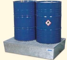
Auffangwanne, feuerverzinkt, mit Gitterrost, für bis zu 2 Fässer à 200 Liter.
