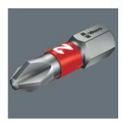
Bits BiTorsion sind absolute Premium-Bits. Mit weicherer BiTorsion-Zone, wodurch die Härte des Schaftes um ca. 20 % gegenüber der Abtriebsspitze reduziert wird. Dadurch wird das Verwinden der Bitspitze bei auftretenden Belastungsspitzen größtenteils vermieden, was die Lebensdauer des Bits noch weiter erhöht.
