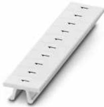
Zackband, Streifen, weiß, beschriftet, beschriftbar mit: CMS-P1-PLOTTER, längs bedruckt: gleiche Zahlen 1 oder 2 usw. bis 100, Montageart: verrasten, für Klemmenbreite: 5,2 mm, Schriftfeldgröße: 5,15 x 10,5 mm, Anzahl der Einzelschilder: 10
