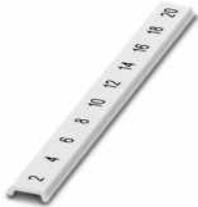
Zackband flach, Streifen, weiß, beschriftet, längs bedruckt: fortlaufende gerade Zahlen 2 ... 20, 22 ... 40, usw. bis 82 ... 100, Montageart: verrasten, für Klemmenbreite: 6,2 mm, Schriftfeldgröße: 5,15 x 6,15 mm, Anzahl der Einzelschilder: 10
