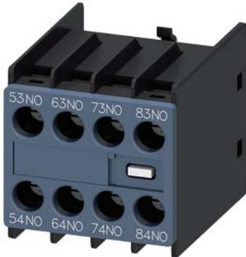
Hilfsschalter, frontseitig, 4 S, 53/54, 63/64, 73/74, 83/84, Strombahn: 1 S, 1 S, 1 S, 1 S, Schraubanschluss, für Schütze 3RT2 und Hilfsschütze 3RH2
